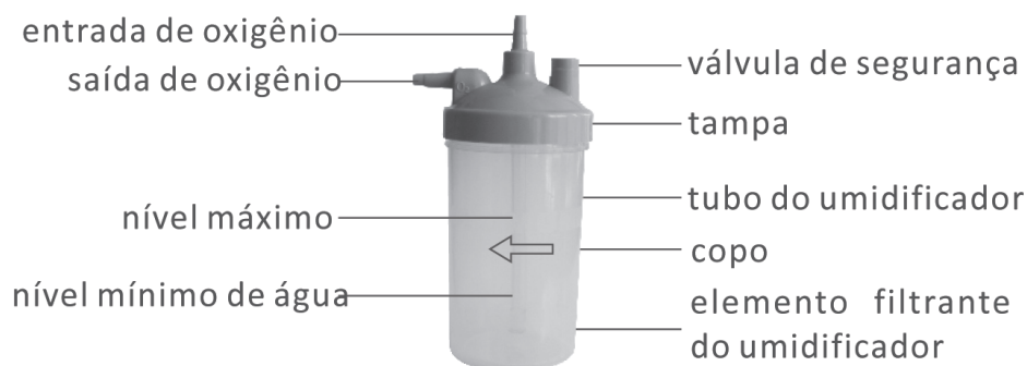
Figura 4: componentes do umidificador
