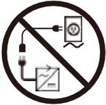
Não conecte um cabo de extensão ao conversor CA/CC ou ao carregador de bateria.
