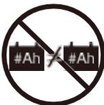
Não use baterias com capacidades diferentes de ampère-hora (Ah). Não misture baterias velhas com novas. Sempre substitua as duas baterias ao mesmo tempo.
