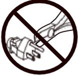
A remoção do pino de aterramento pode criar risco elétrico. Se necessário, instale adequadamente um adaptador de 3 pinos aprovado em uma tomada elétrica com acesso a plugue de 2 pinos.
