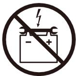
Mantenha ferramentas e outros objetos metálicos longe dos terminais da bateria. O contato com ferramentas pode causar choque elétrico.
